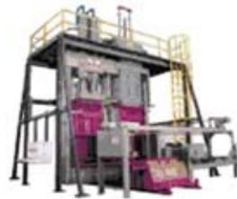
**BAJAJ FULLY AUTOMATIC DOWN PACKING BALING PRESS**
